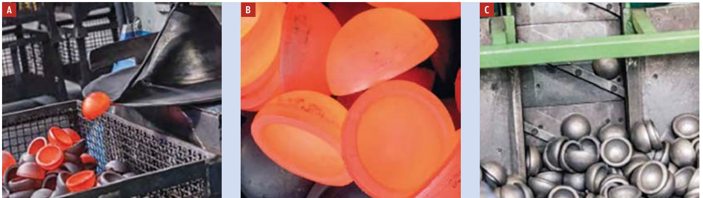
FIGURE 7 : (a) Lopins issus de l'opération de cisailage. Illustrations du procédé d'estampage - matriçage. (b) Illustrations du procédé d'estampage - matriçage. (c) Illustrations du procédé d'estampage - matriçage. [2]
