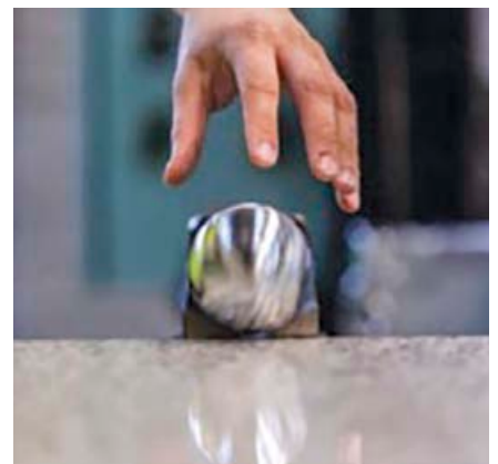
FIGURE 2 : Passage au marbre : test d'équilibrage [2] .
