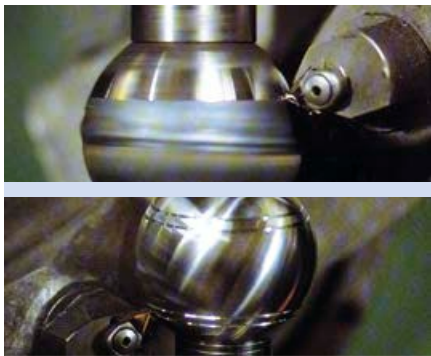
FIGURE 10 : (a) Illustration des opérations de tournage et striage. (b) Illustration des opérations de tournage et striage.
