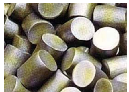
FIGURE 6 : Lopins issus de l'opération de cisailage.
