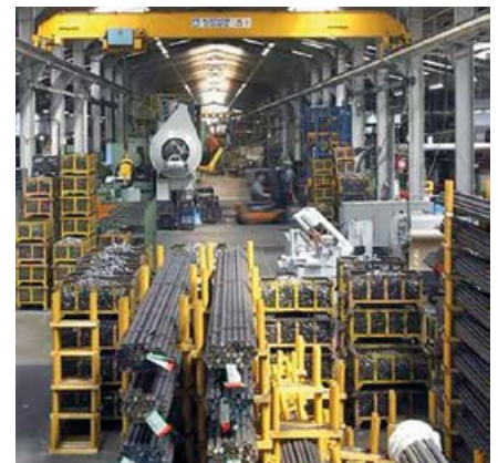
FIGURE 5 : Barres de diamètre 40 mm utilisées pour la fabrication des boules. (en arrière plan : presse utilisée pour réaliser les coquilles). [4]
